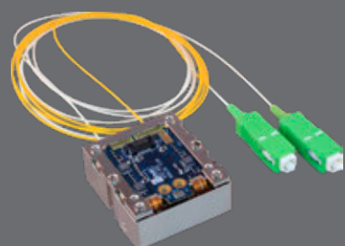
ממיר RF לאופטיקה (RFOF) למערכות WiFi ו- IFE מבוססות SATCOM
