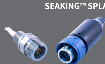
SEAKING™ SPLASH 10K PSI במצב פתוח או מחובר, סדרת מחברים אטומים ללחץ 10K PSI גם במצב לא מחובר. חיבור קל ומהיר תוך כדי צלילה
