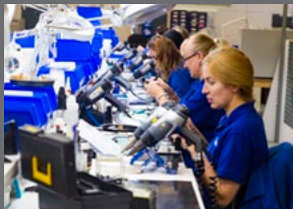
הרכבות רתמות מחברים וכבלים אופטיים בנוסף לסדרות מיקר וננו
